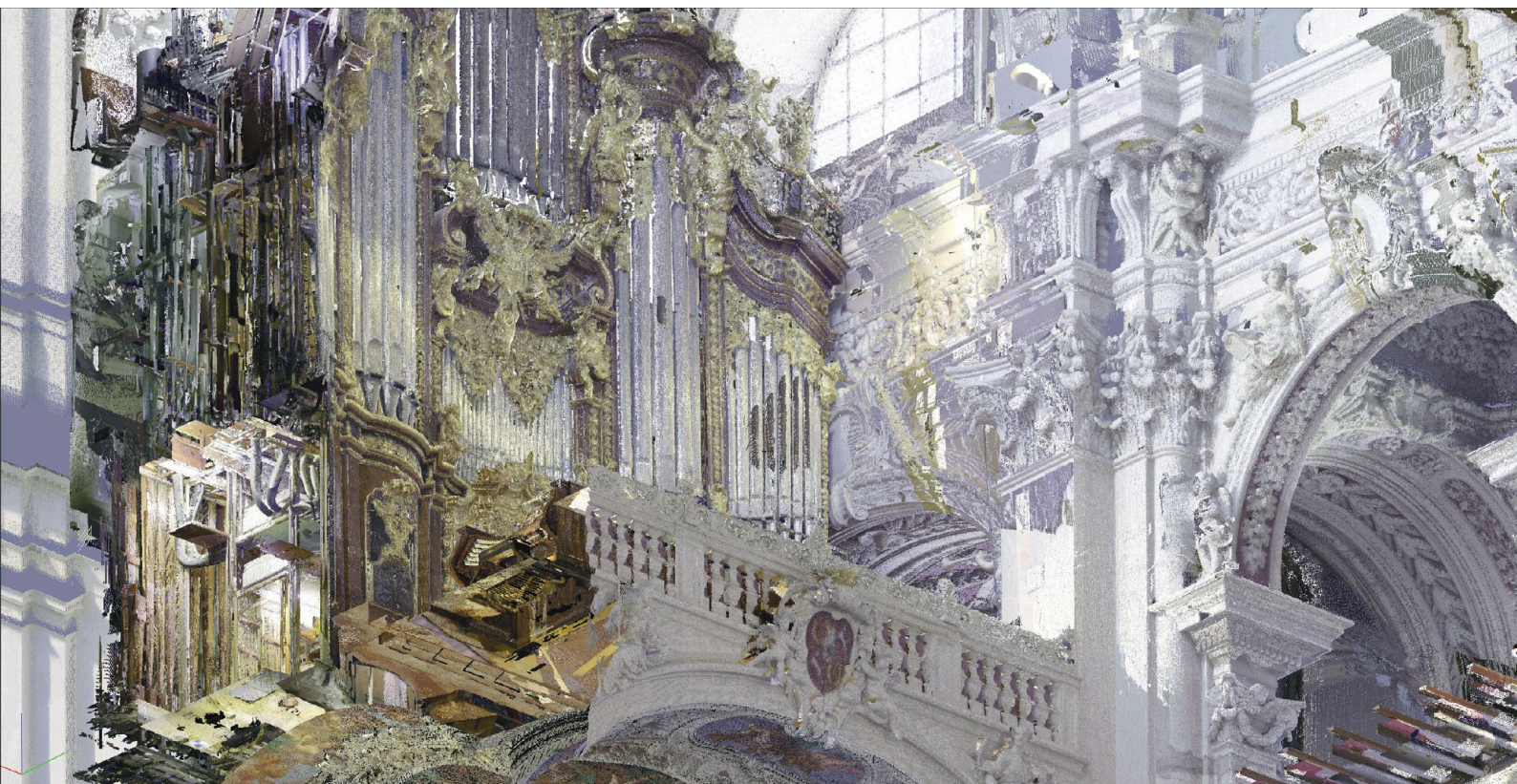
6 Die 3D-Punktwolke zeigt auch Details im Innern der Orgel | The 3D point cloud also shows details inside the organ | Le nuage de points 3D montre également des détails à l'intérieur de l'orgue
