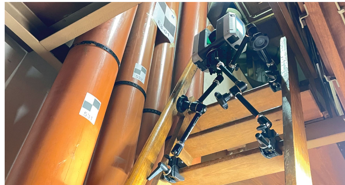
8 „Tentakel-Scanner“: 3D-Scanner, montiert auf der selbst gebauten Halterung | „Tentacle scanner“: 3D scanner, mounted on the self-built holder | « Scanner à tentacules » : scanner 3D monté sur le support qu'il a lui-même fabriqué
